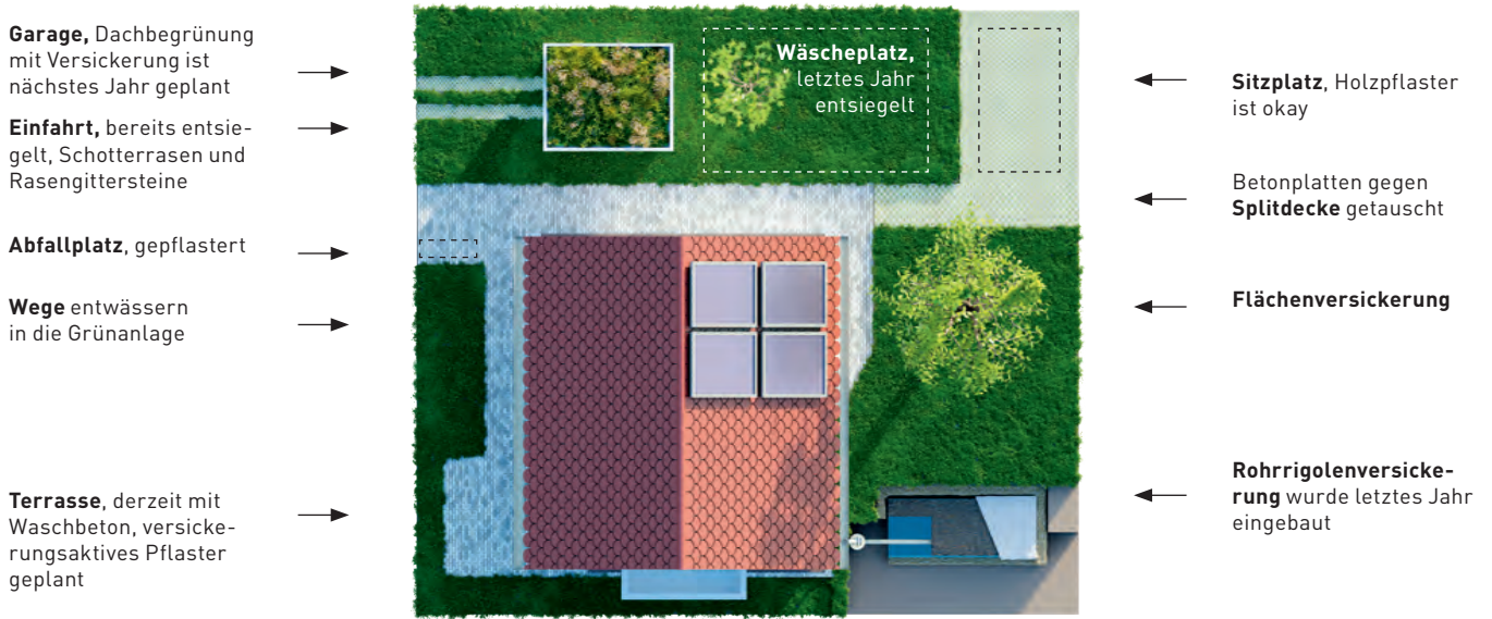
Abbildung 16: Möglichkeiten der Entsiegelung von Flächen und Versickerung von Niederschlagswasser auf dem Grundstück – Beispiel einer geplanten Umgestaltung
